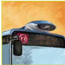
Teor est équipé du guidage optique. De quoi s'agit-il ? Une caméra située sur le bus lit un marquage peint sur le sol. Un ordinateur analyse ce marquage et transmet les informations à la colonne de direction. Le volant du véhicule va alors tourner tout seul pour
