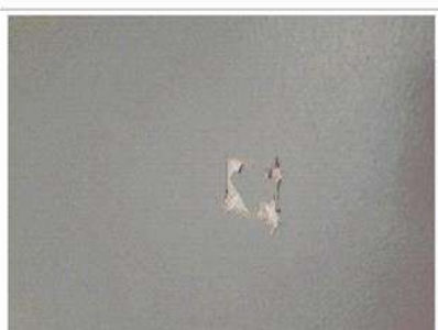
Prélèvement - P009 : Rez-de-chaussée / Pièce 1 - Peinture- (Absence d'amiante)
