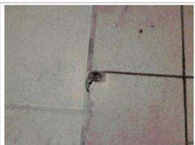
Prélèvement - P001 : Rez-de-chaussée / Pièce 1 - Colle de carrelage- (Absence d'amiante)
