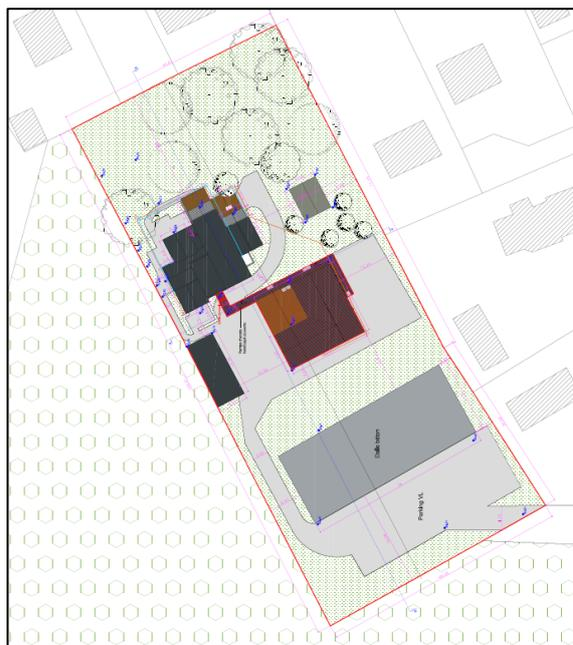
Le projet prévoit l'extension de 65 m<sup>2</sup> du bâtiment Atelier de jour existant (portant sa surface de 242m<sup>2</sup> à 307m<sup>2</sup>, la réhabilitation du second bâtiment de l'ESAT sur 152m<sup>2</sup> et de réunir les deux bâtiments par un cheminement couvert respectant les normes PMR (Personnes à Mobilité Réduite).
