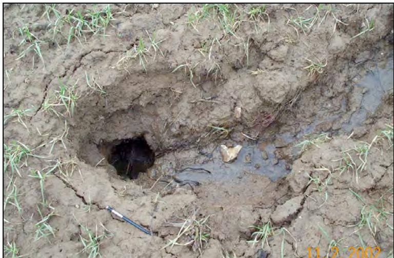
Figure 13 : Point d'infiltration localisé des eaux de surface, diamètre 0.30m, profondeur 0.10m, commune de Graimbouville (76) [LRPC de Rouen, 2002]
