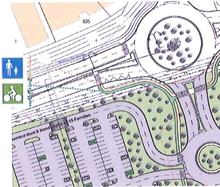
Extraits de plan Masse montrant le principe de répartition des modes, GEPPEC
