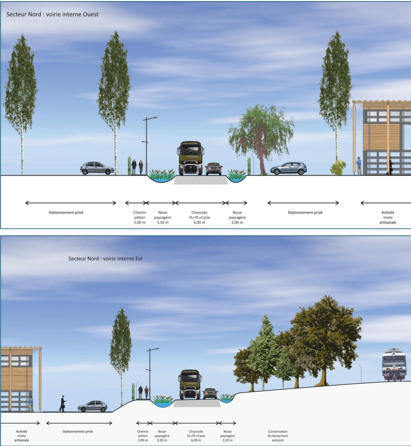
Figure 19 : Coupe de principe des voiries et des noues sur l'axe de desserte interne (en haut : sur la partie Ouest, au moment où la voirie interne est centrale ; en bas : sur la partie Est quand la voirie se situe entre les parcelles et la voie ferrée).
