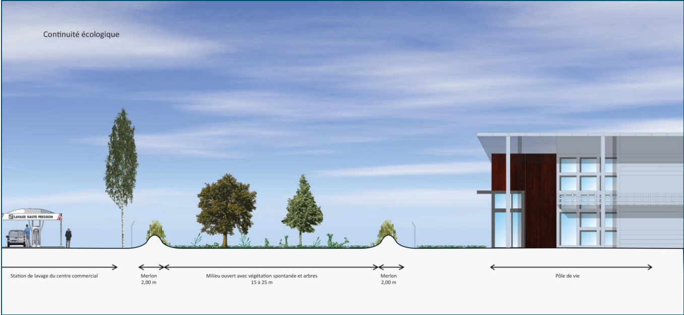
Figure 18 : Coupe de principe de l'axe de desserte à l'Ouest du Parc « Les Coutures »
