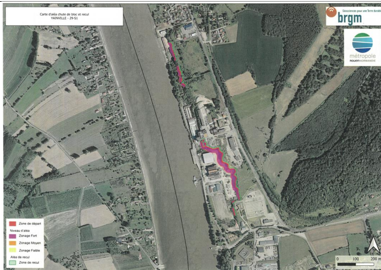
Figure 28 : Cartographie actualisée des risques liés à la présence de falaises sur la commune de Yainville - BRGM
