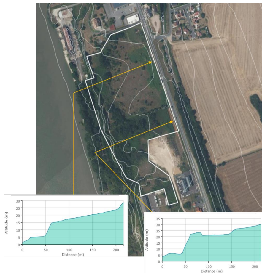
Figure 27 : Profils altimétriques sur le site - GAMA Environnement
