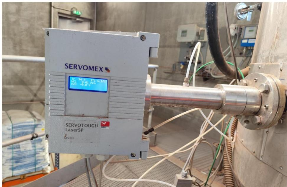
Appareil 3 : Analyseur 4 gaz (CO / O2 / Nox / SO2)
