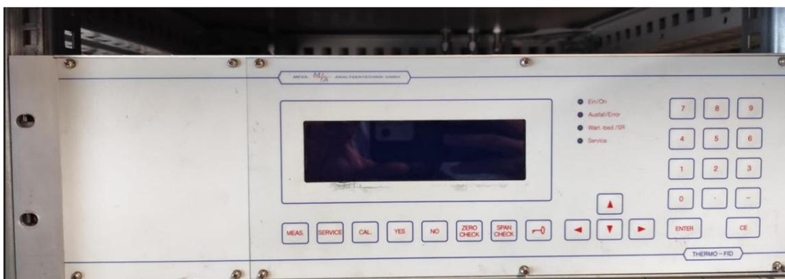
Appareil 2 : Analyseur laser hcl h2O
