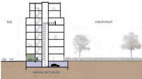
Coupe et schéma de principe Accessibilité directe au parkings pour chaque immeuble
